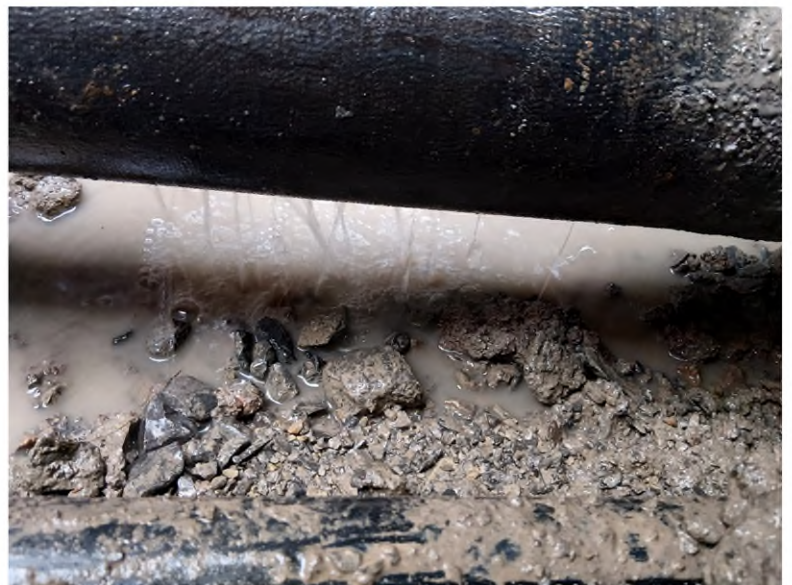
Rohrbruch und weitere Schäden am Rohr
