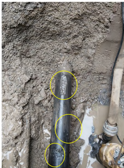
Rohrbruch und weitere Schäden am Rohr
